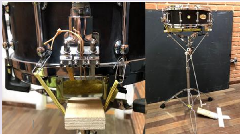
Fig. 6: À esquerda, detalhe do elástico de borracha acoplado ao aro e a ripa de madeira. À direita, instrumento montado com o sistema completo.
