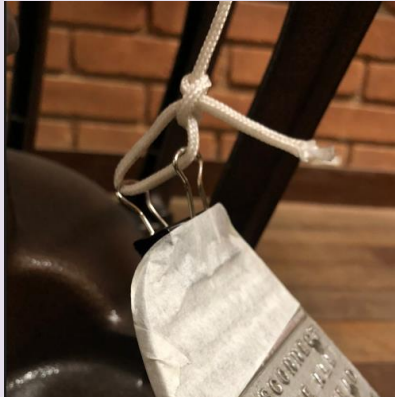
Fig. 2: Opção de presilha para conectar o barbante ao pedal.
