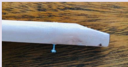
Fig. 8: Colocar um parafuso de 2 cm no furo de baixo.
