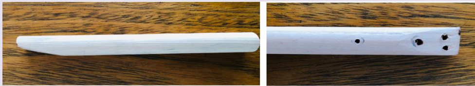
Fig. 7: Cortar dois pedaços de um cabo de vassoura com cerca de 18 cm. Cortar de forma diagonal uma ponta de cada cabo e fazer quatro furos em cada um.
