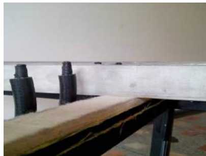
Fig. 18: Barra de abafamento acionada e em contato com a tecla.
