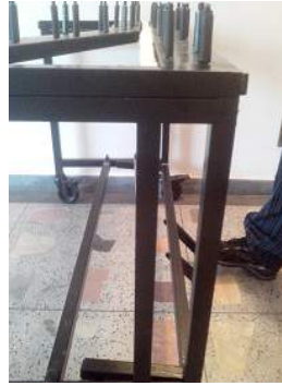
Fig. 58: Barra de abafamento em repouso.
