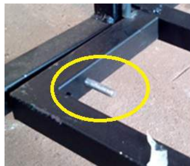
Fig. 52: Parafuso guia da barra de articulação e sustentação do pedal.
