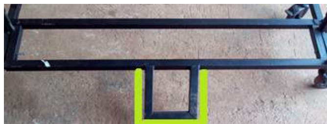
Fig. 48: Pedal acoplado à barra de articulação – Protótipo I.
