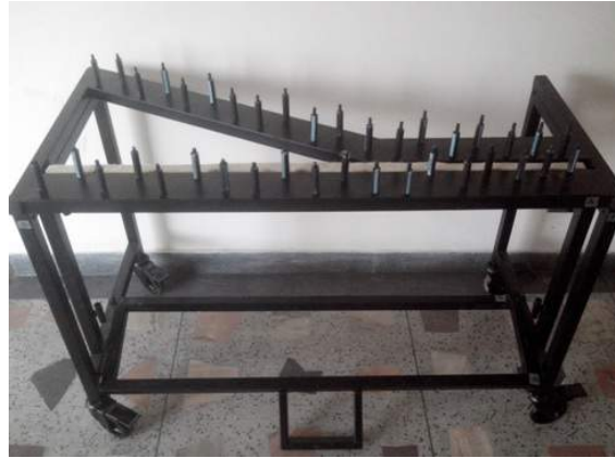
Fig. 47: Protótipo II – frame com mecanismo de abafamento sem as teclas.
