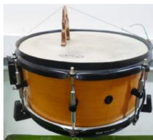
Fig. 02: Caixa preparada com corda e cavalete de violoncelo, utilizada na pesquisa. É possível notar o cavalete mais próximo a uma das extremidades da corda resultando em uma região menor (mais aguda) e outra maior (mais grave).
