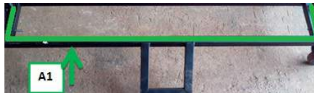
Fig. 51: Barra de articulação do eixo vertical.
