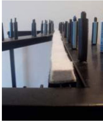
Fig. 17: Barra de abafamento acionada.
