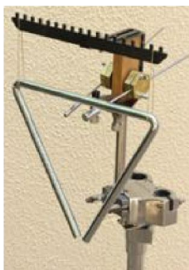
Figura 2 – SIBAPIS2020 finalizado com triângulo suspenso e duas baquetas
