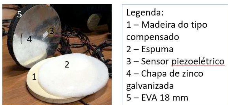
Fig.3: Composição do pads utilizados para os tambores.
