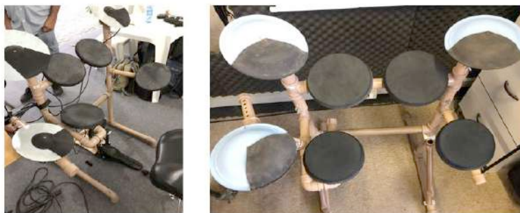
Fig.4: À esquerda, bateria na versão antiga com prato de chapa de zinco galvanizada e à direita, bateria atual com prato de plástico.
